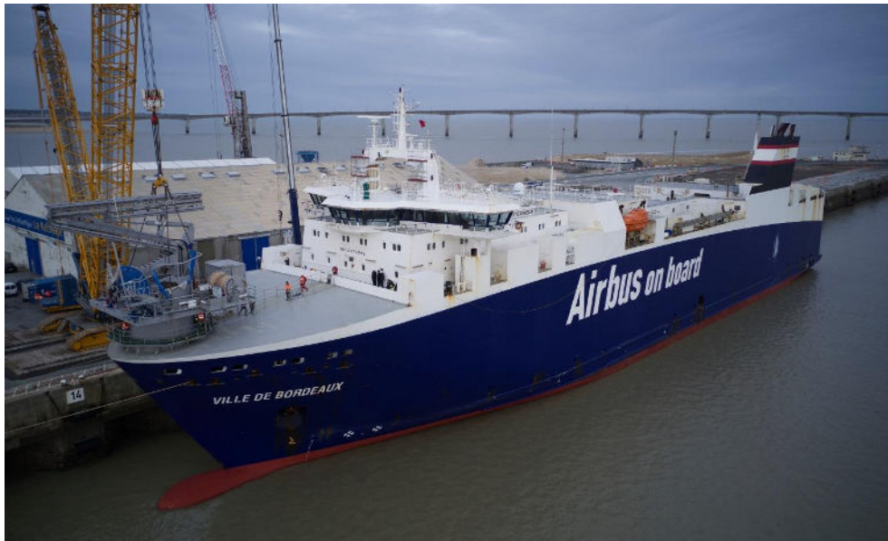
Seawing installé à l'avant du pont du « Ville de Bordeaux » ©Cinétique Films pour Airseas
